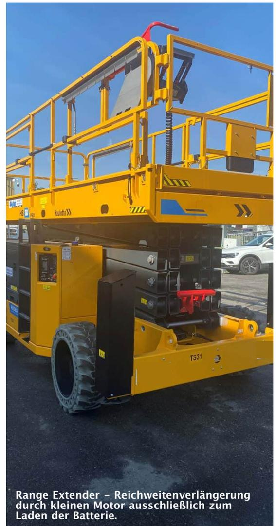
Range Extender – Reichweitenverlängerung durch kleinen Motor ausschließlich zum Laden der Batterie.
